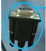
시리얼 포트 GNSS Receiver management PC 용 프로그램과 연결할 때 사용
