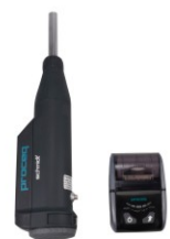
콘크리트 테스트 햄머
