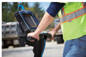
〈SIR4000 - GPR 데이터 획득 시스템〉
